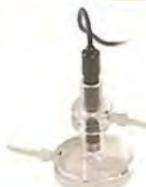
將軟管放入液體內後，用針筒將液體送入儀器內，攪拌液體後，即可測定。適合飲料產品的 DO 測定
