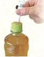
裝有注射計的筆型採樣器，可輕易刺入硬質樹脂製的瓶蓋。適合飲料寶特瓶產品
