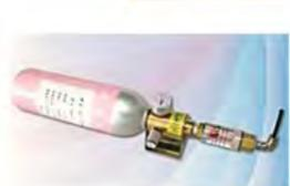
使用標準氣體，即可當場確認儀器的精度。當儀器老舊或因測定環境產生誤差時，可使用標準氣體確認精度。
