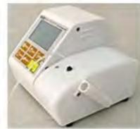
使用於標準品的幫浦無法自動吸入的強壓或真空包裝。通常為包裝內壓為 -30kPa 以下的減壓時使用，如鋁罐、寶特瓶。
